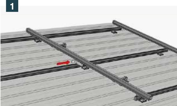
Asegurese de que se hayan retirado los paneles solares alrededor del lugar donde se coloca el soporte de ángulo recto de aluminio.
