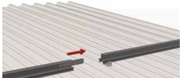
A continuación, se debe asegurar en un lado realizando el movimiento correcto hacia arriba con la herramienta de montaje (asegúrese de que este bloqueo se encuentra en el mismo lado en todas las conexiones).
