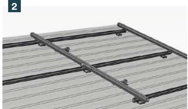
Coloque el soporte angular de aluminio en la parte inferior del inserto IP donde se coloca el ultimo panel solar con retorno.
